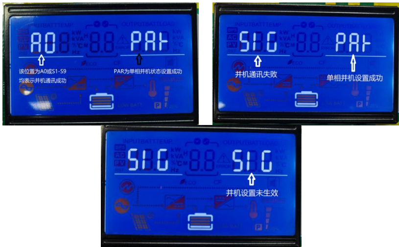
图 4.1.1 并机设置成功，通讯成功界面, 并机设置成功，通讯失败界面 并机设置失败界面
